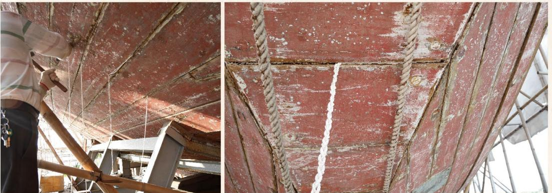
整個修復作業，除了主桅外，船體外殼的捻縫處理，也是一大重點。「捻縫」是木造船的傳統技術之一，古代木船之所以不會進水，就是用植物纖維當船板縫隙間的內層填料，再用桐油與石灰做成的「油灰」當外面的隔水塗層，達到防水的目的；臺灣成功號原本規劃能夠航行，因此是用樹皮塑形成的紗來填縫，如今考量臺灣成功號已確定不再航行，改以棉繩為填料，外塗油灰作為替代方案，以利未來維護管理。
