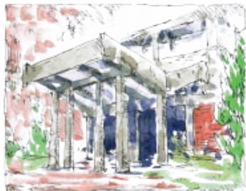
「其中最大膽的嘗試便是大門頂棚的設計，刻意將屋頂的造型翻轉過來，造成上揚的效果，與中國傳統的大門設計完全不同。大門的比例也不同於時下慣用的寬門，而採用較瘦長的形狀。另外在外牆的部分是巧妙地將空心磚直立堆疊，不按照較常見的作法，而形成另一種創意。且與梁柱接合處也刻意留下縫隙，不完全地密合，造成一種中國式的疏透之美。當午後樹木的陰影投射在刷白的牆壁上，更能呈現出搖曳斑駁的光影之美。」
